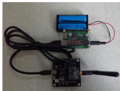
图 2.28 终端节点与电池连接
