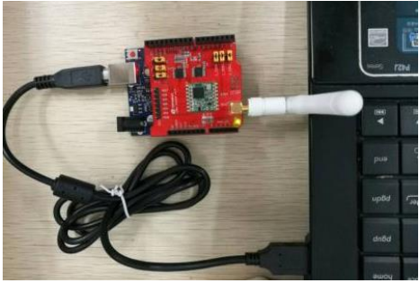
图 37.15 信号发送板通过串口连接 PC
