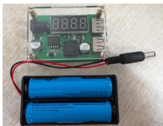
图 24.3 电池及 5V 稳压模块
