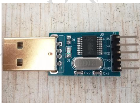
图 16.7 USB 转串口模块
