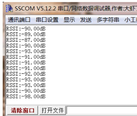
图 2.42 封闭金属壳对 RSSI 值影响
