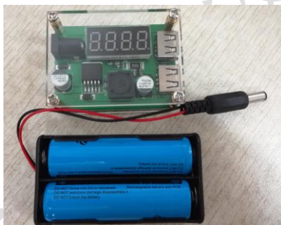
图 26.8 电池及 5V 稳压模块
