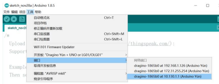
图 33.37 切换网络端口
