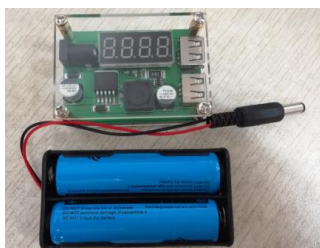
图 17.3 电池及 5V 稳压模块
