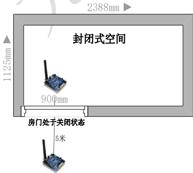
图 2.39 封闭墙体场景
