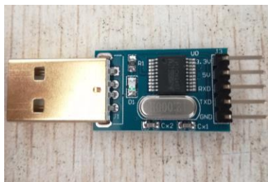
图 19.11 USB 转串口模块
