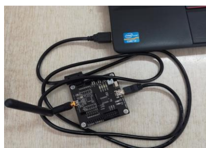
图 17.7 终端节点连线实物图 图 17.8 协调器节点与笔记本 PC 连接
