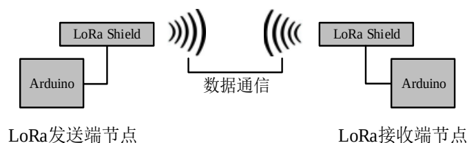
图 33.2 LoRa 节点间数据传输原理图
