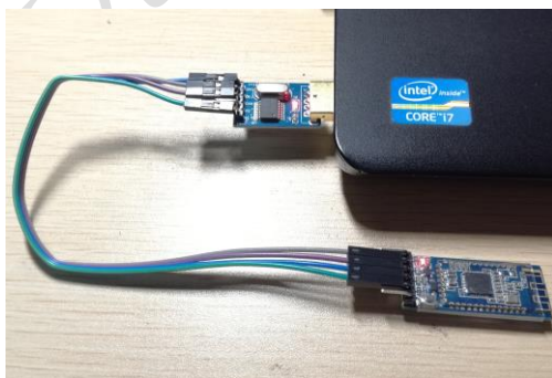
图 16.21 USB 转串口模块连接至 PC
